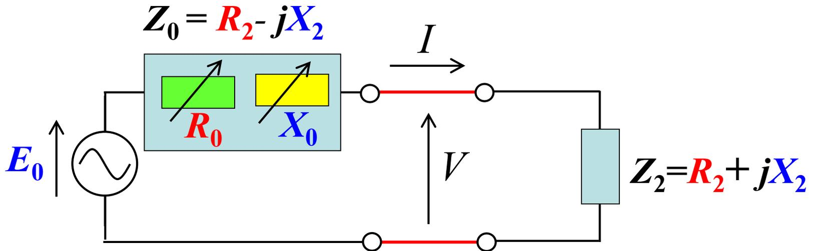
例題では、等価電源インピーダンスを可変にするための変数は  $\omega$  のみであったが、実は**理想変成器の巻線比率**が隠し変数となっている(既に最適化されている)
