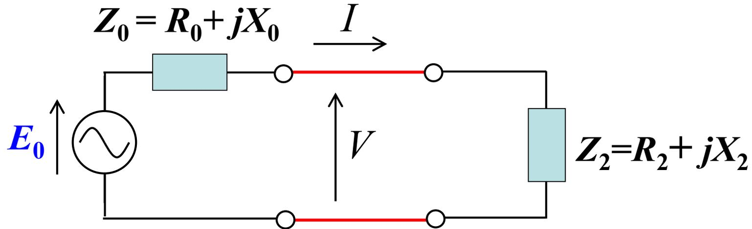
内部インピーダンス  $Z_0$  の電源から負荷インピーダンス  $Z_2$  の抵抗  $R_2$  に供給される有効電力  $P$  は
